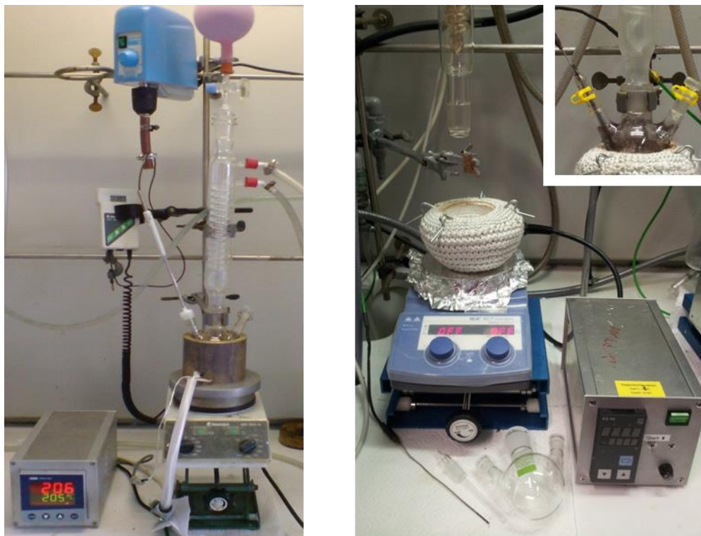
Abb. 14-1. Versuchsaufbau Nanopartikelsynthese. Per Temperaturregler gesteuertes Metallbad (links) oder Heizpils (rechts).
