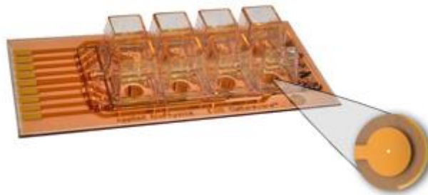
Abb. 7-11. Aufbau der Elektrodenzellen (8W1E) für ECIS-Messungen ( www.biophysics.com ).
