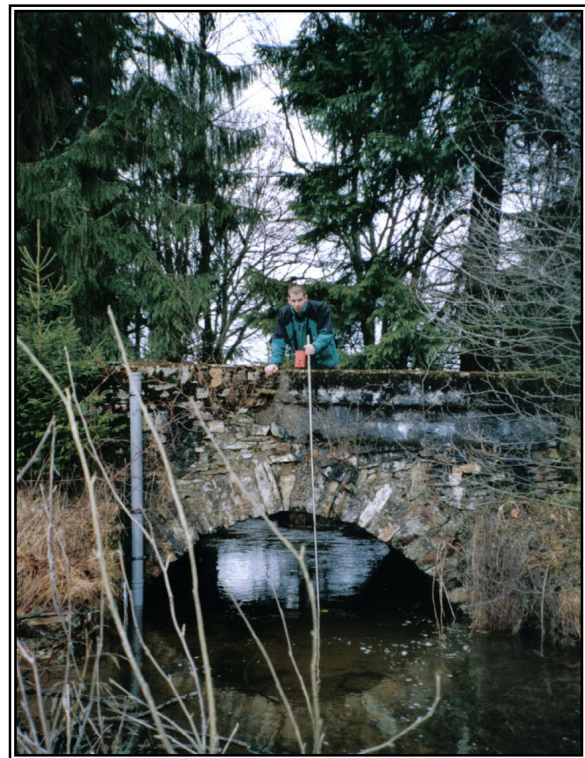
Bild 4-4 Messung mit dem hydrometrischen Flügel an Messpunkt P5 (Gräfenbach) im Februar 2004.
