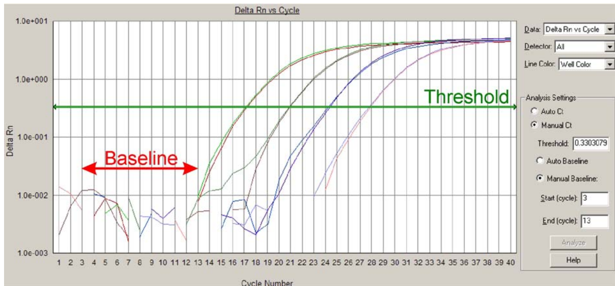
Abbildung 2-3: Amplifikationsplot einer seriellen 10fach Verdünnungsreihe von Plasmiden (Standardreihe von 10^8 bis 10^4 Kopien). Aufgetragen ist die Zyklennummer gegen das mit ROX normalisierte (s. u. Durchführung der qRT-PCR.-2 ) Fluoreszenzsignal. Die Baseline legt das Hintergrundrauschen des Fluoreszenzsignals fest, der Threshold (Schwellenwert) die Stärke des (normalisierten) Fluoreszenzsignals, bei dem gemessen wird. Der Ct-Wert ( C ycle of t hreshold) einer Probe ist definiert als der Zyklus, in dem der Schwellenwert durchschritten wird.
