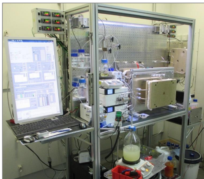
Abbildung 6-12: Typischer Aufbau zur Charakterisierung des CdSe@ZnS Prozess im HIMIX mit nachgeschaltetem Sandwichreaktor.
