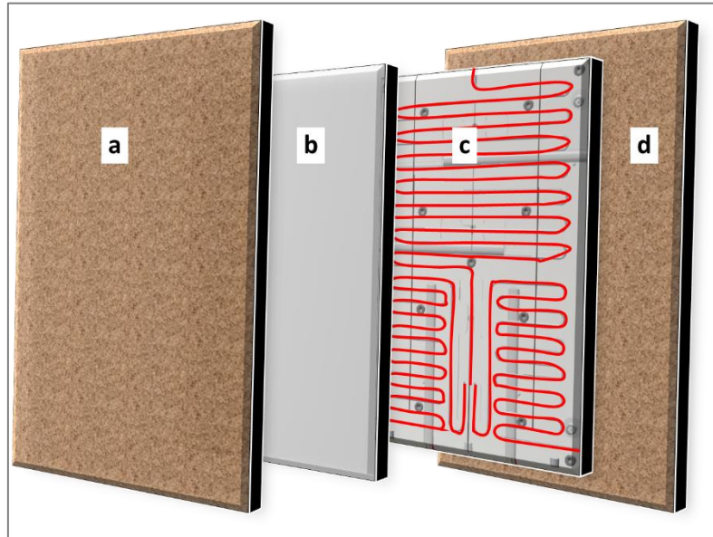
Abbildung 6-9: Schema des HIMIX. a) Isolationsplatte aus Vermiculit; b) Aluminiumabdeckung; c) Aluminiumplatte mit Einkerbung für den Einsatz einer 1/16" Kapillare; d) Isolationsplatte aus Vermiculit.
