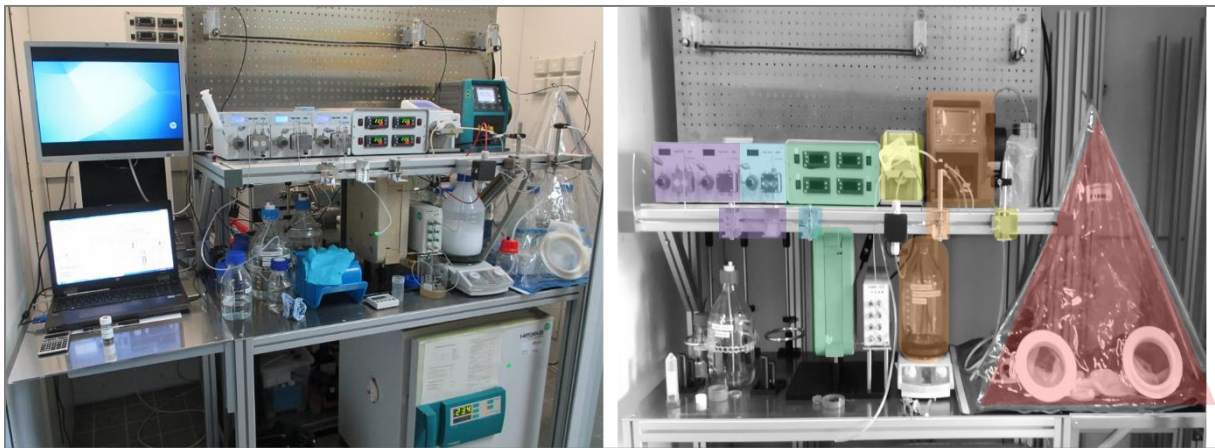
Abbildung 5-52: Aufbau zur kontinuierlichen Synthese von \text{Cu}^0 -Nanopartikeln und Zinkoxalat-Gel zur Herstellung von Cu/ZnO-Katalysatoren. Violett) Fördern und Mischen der Cu-Komplex-Emulsion; Blau) Fördern und Mischen des Reduktionsmittels; Grün) Mikroreaktor mit Temperaturregelung; Orange) Füllen und Fördern des Zinkoxalat-Gels; Gelb) Zudosierung der Ölsäure; Rot) Aufreinigung und thermische Behandlung
