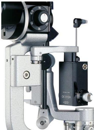
Abbildung 4: Goldmann-Tonometrie an der Spaltlampe (mit freundlicher Genehmigung von Haag-Streit Deutschland GmbH)
