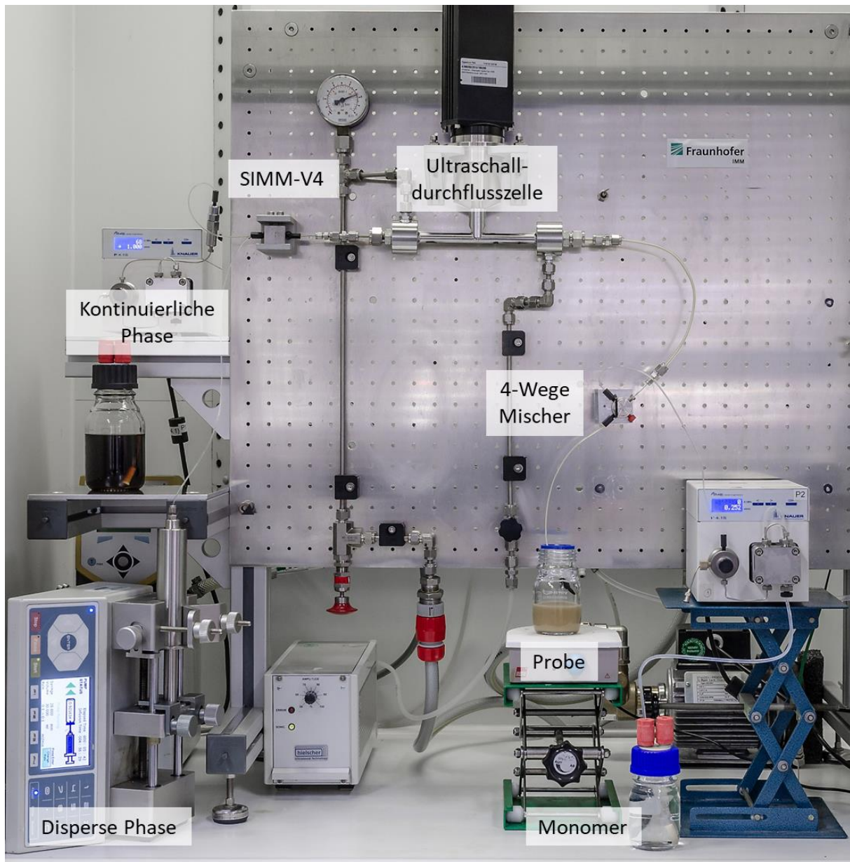
Abbildung 5.9: Foto der Anlage zur Herstellung von Polyurea-Kapseln mit einem organischen Kern aus Limonen
