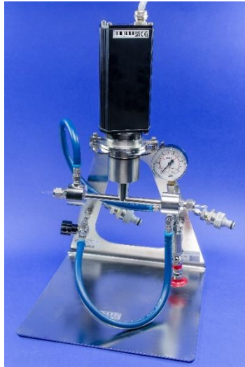
Abbildung 2.19: Aufbau und Prinzip einer Ultraschalldurchflusszelle
