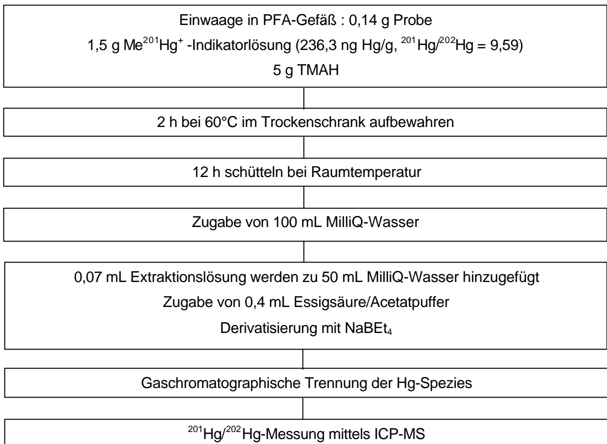
Abb. 33 Basisches Aufarbeitungsschema zur Bestimmung von \text{MeHg}^+ im Referenzmaterial CRM 463 mittels GC/ICP-MS/MS
