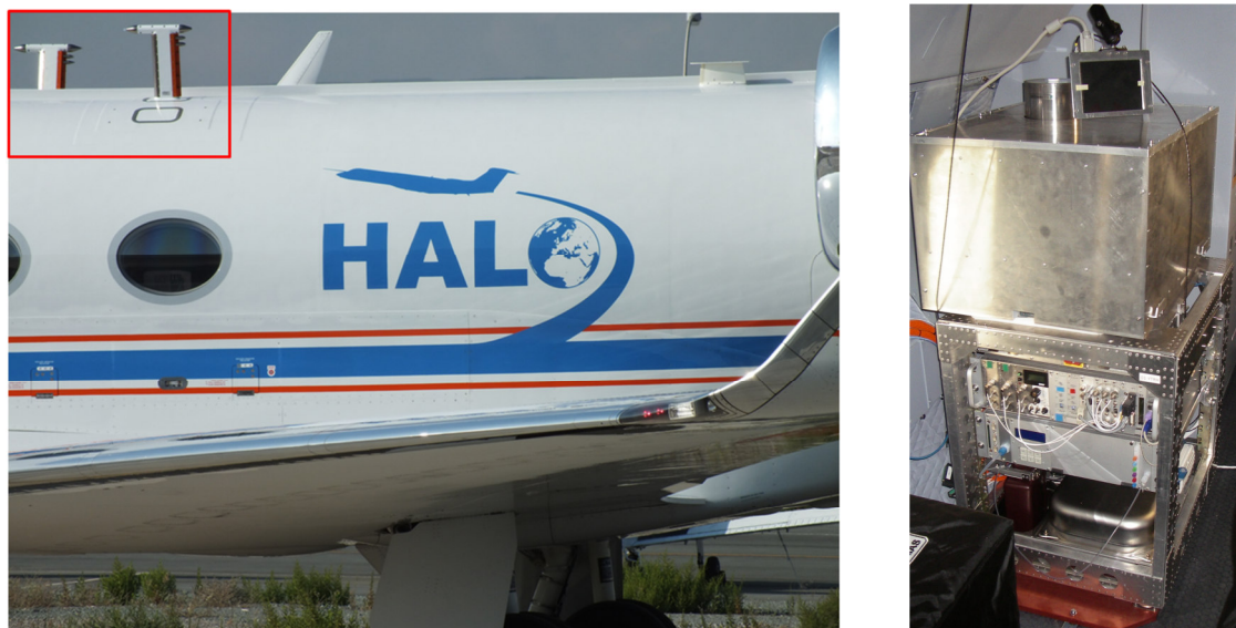
Abbildung 27: Fotos von Rack und TGIs in HALO. Zwei der hinteren TGIs auf der Außenseite von HALO (rote Umrandung) sind in der linken Abbildung zu sehen. Das TRIHOP-Rack ist auf der rechten Seite zu sehen.
