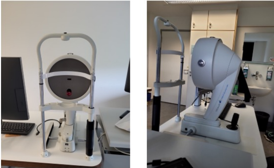
Abbildung 12: Aufbau der Scheimpflug-Kamera Pentacam® HR
