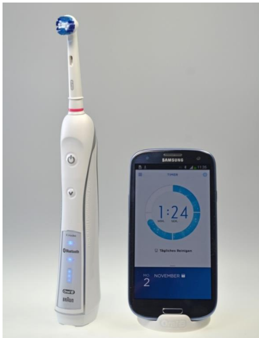
Abb. 14: Kommunikation von Zahnbürste und Smartphone-App. Bildlich auf dem Display dargestellt ist die bereits geputzte Zeit mit zu putzendem Quadranten (120).
