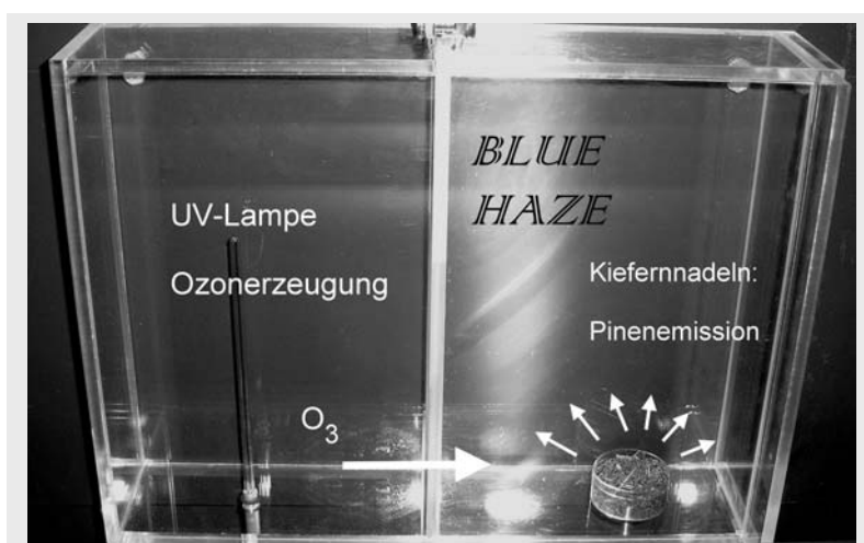
Abb. 143-4: Visualisierung der Partikelbildung durch Ozonolyse von Terpenen im Demonstrationsversuch. Eine mit Ozon und eine mit Kiefernnadelemmissionen gefüllte Versuchskammer werden in Kontakt gebracht, der Dunst im Lichtstrahl beobachtet.
