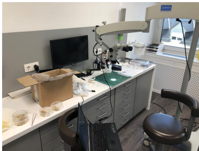
Abbildung 19: Aufbau der Nachuntersuchung mittels Zumax OMS 2350 Lichtmikroskop
