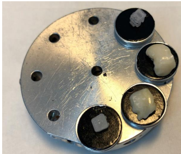
Abbildung 9: Untersuchungshalterung mit Damon® Clear™ - Testgruppe von li nach re: Damon® Clear™ Bracket nach Laser-Debonding, Kunststoffreste auf Schmelzoberfläche nach Debonding, polierte Zahnschmelzlamelle nach Entfernung Kunststoffreste, werksneues Damon® Clear™ Bracket
