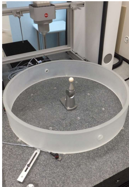
Abbildung 1: Isolatorring auf Koordinatenmessgerät
