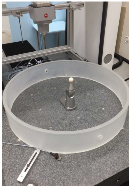
Abbildung 1: Isolatorring auf Koordinatenmessgerät
