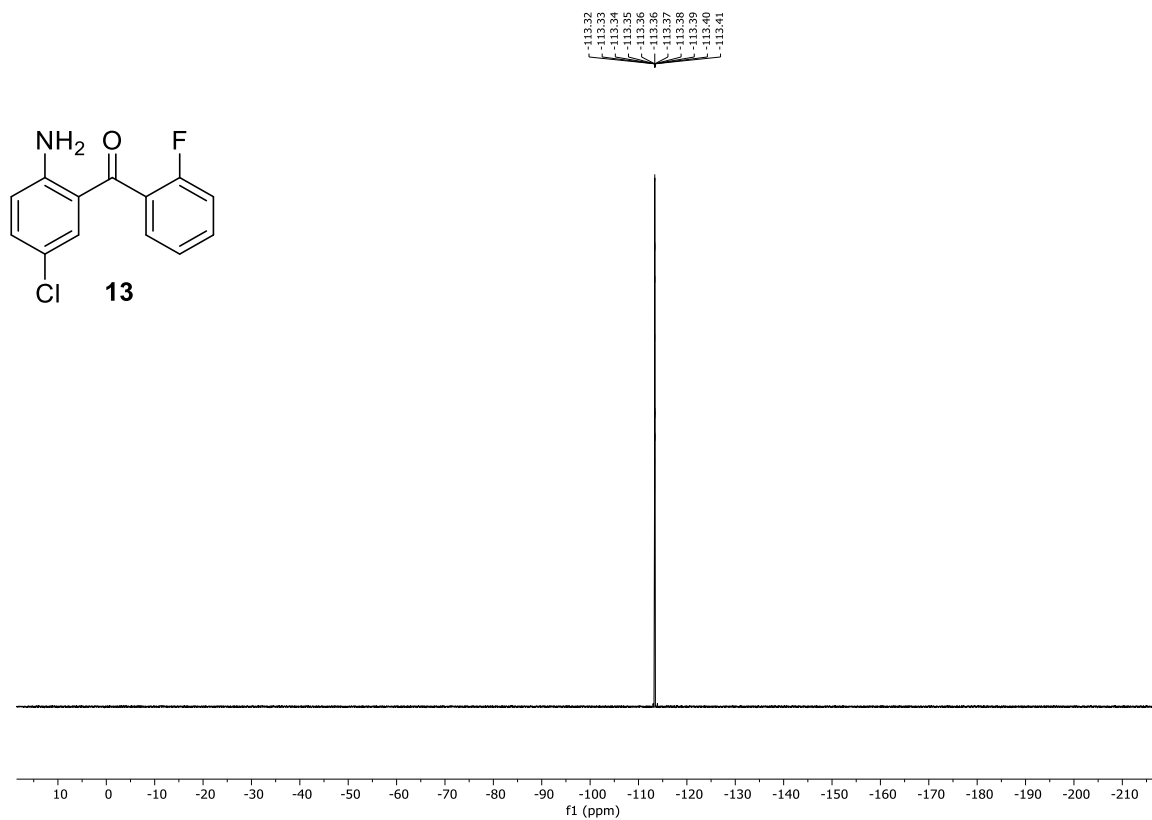
Spektrum 9.1-3: ^{19}\text{F} -NMR (282 MHz, \text{CDCl}_3 ) von Verbindung 13 .
