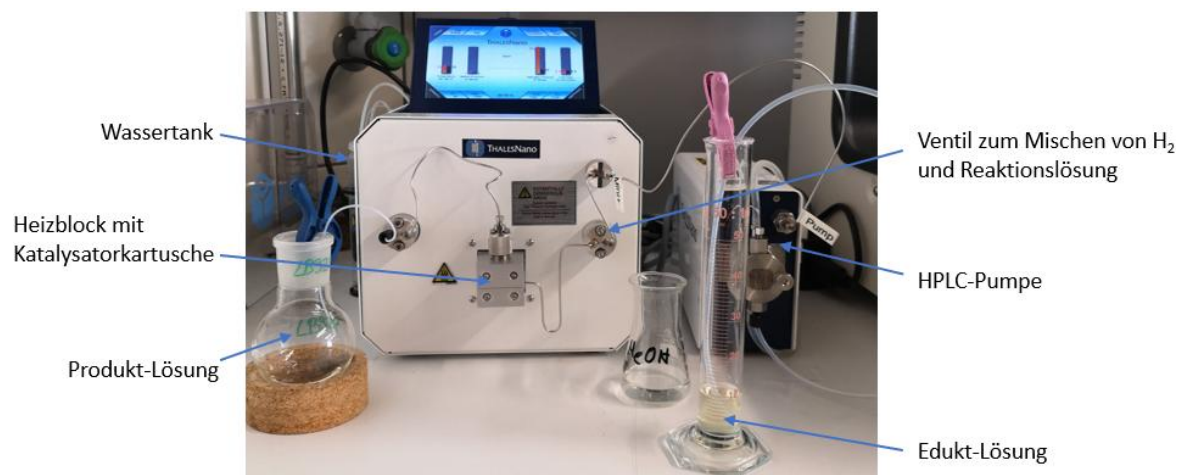
Abbildung 4.3-1: Übersicht des Aufbaus für die Flow-Reduktion mit dem H-Cube ® Mini Plus.
