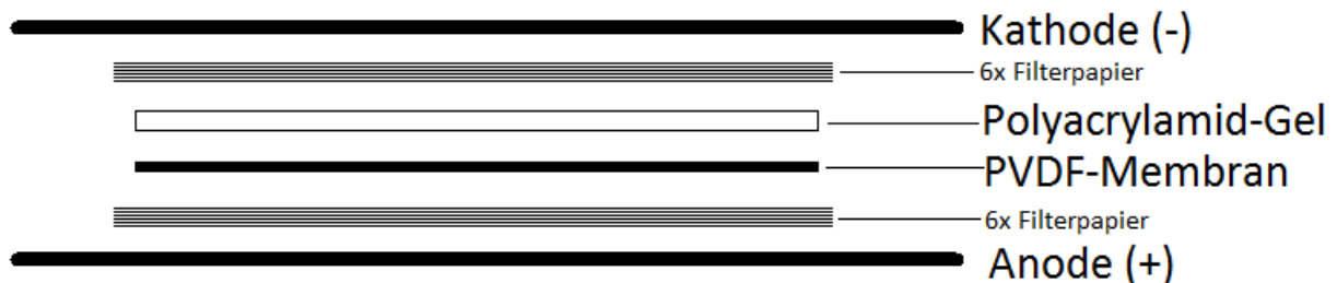
Abbildung 4 Aufbau des verwendeten semi-dry Blots
