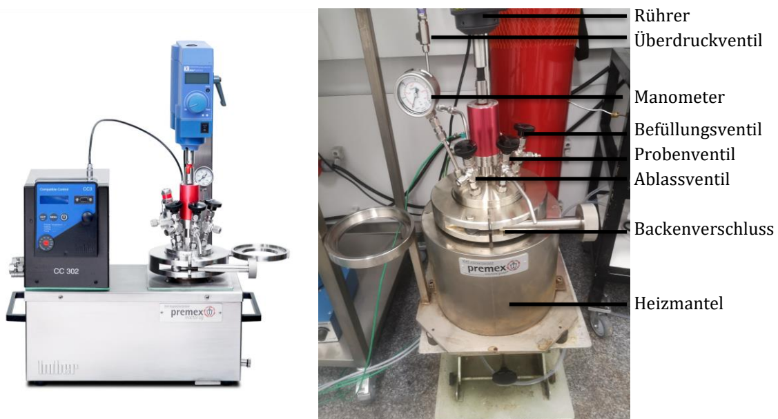
Abbildung 23: links: Hochdruckreaktor Modell "beluga"; rechts: Hochdruckreaktor Modell "twister light".
