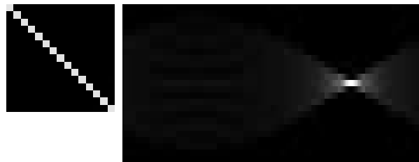
Abbildung 2.9: Links das Ausgangsbild mit einer diskreten Linie. Rechts das dazugehörige Sinogramm in dem sich eindeutig ein Peak heraushebt. Die Radon-Transformation steht im direkten Zusammenhang zur Hough-Transformation. Anhand des Peaks im Hough-Raum kann die Gerade identifiziert werden.
