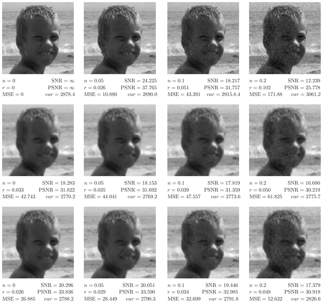
Abbildung 4.2: Obere Reihe: Von links nach rechts wurde dem 128 \times 128 Originalbild (links) stärkeres Rauschen hinzugefügt. Mittlere Reihe: Obere Bildreihe gefaltet mit dem Meanfilter. Untere Reihe: Die obere Reihe gefaltet mit dem Gaußfilter.
