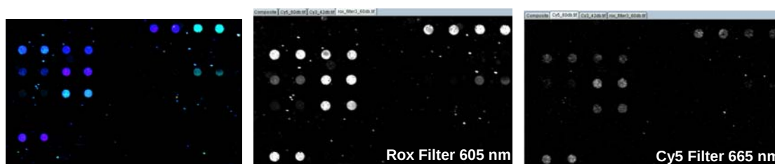
Abbildung 19: a) composite scan und die Abbildung des grünen Kanals mit einem TAMRA -Filter (580 nm) und des grünen Kanals mit dem Filter für Cy3 (570 nm); b) composite scan der Minisequenzierungsreaktion mit SNaPshot™ Kit Farbstoffen. Nachweis, dass der Rox -Farbstoff mit dem Emissionsspektrum des Cy5 -Farbstoffs überlappt.
