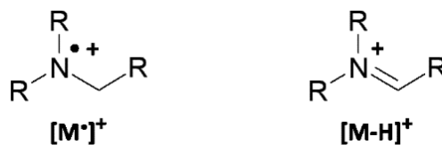
Abbildung 63: Molekölion und stabilisiertes Ion nach Abstraktion eines Wasserstoffatoms (R = aliphatischer Rest, oder Wasserstoffatom)
