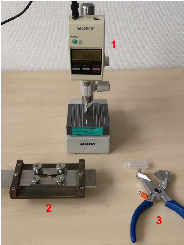
Abbildung 36: Manuelle Vermessung der Polyethylenschichtdicke. 1 = Messgerät mit Digitalanzeige. 2 = Metallschlitten zum Einspannen der Inliner. 3 = Schlauchschere zum Freischneiden der PE-Inliner.
