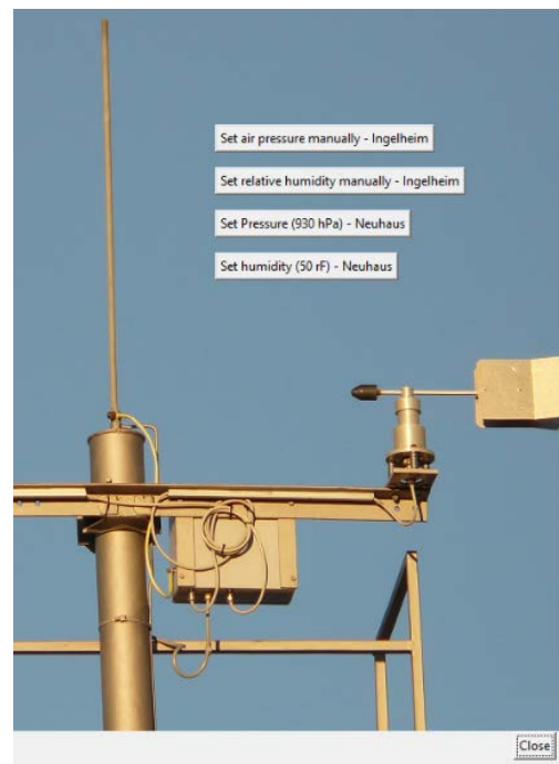
Abbildung 42: Optionale Eingabemöglichkeit von absolutem Luftdruck und relativer Luftfeuchte in Absolutwerten. Umstellung von automatisch zu manuell möglich.
