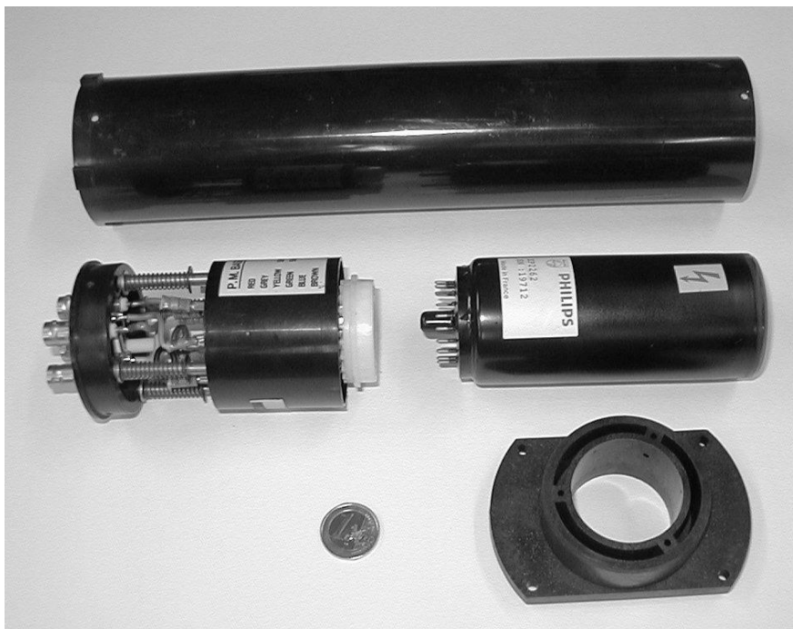
Abbildung A.5: Zusammenstellung der Komponenten eines Photondetektors, dessen Kernstück eine Röhre des Typs EMI9954B bzw. XP2262 ist. Abgebildet ist neben dem Photomultiplier die Base, das Plastikgehäuse und die Lichtleiterklemme aus Kunststoff.
