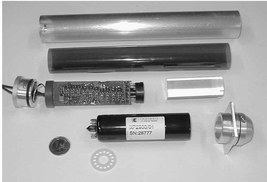
Abbildung A.2: Photographie der Komponenten eines Zählers des H51 Hodoskops (ohne Szintillator). Abgebildet sind Base, Photomultiplier und Lichtleiter so wie das Aluminiumrohr mit einem Rohr aus isolierender Kaptonfolie und der Klemme für den Lichtleiter, die in diesem Fall in das Rohr geklebt wird. Nicht abgebildet ist ein Rohr aus Mumetall, das den Photomultiplier vor magnetischen Feldern schützt.
