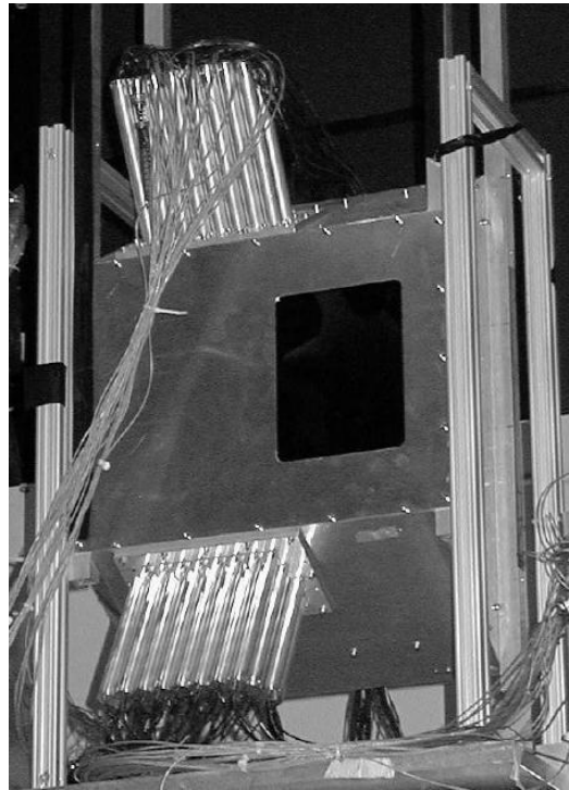
Abbildung 7.7: Photographie des H4I (Betrachtungsrichtung = Strahlrichtung). Man sieht auf der rechten Seite das Folienfenster für den Strahl. Die Aluminiumröhren, die oben und unten aus dem Kasten ragen, beherbergen die Photomultiplier und Basen. Man sieht die vierreihige Staffelung der Elemente sowie deren Neigung um 30^\circ .
