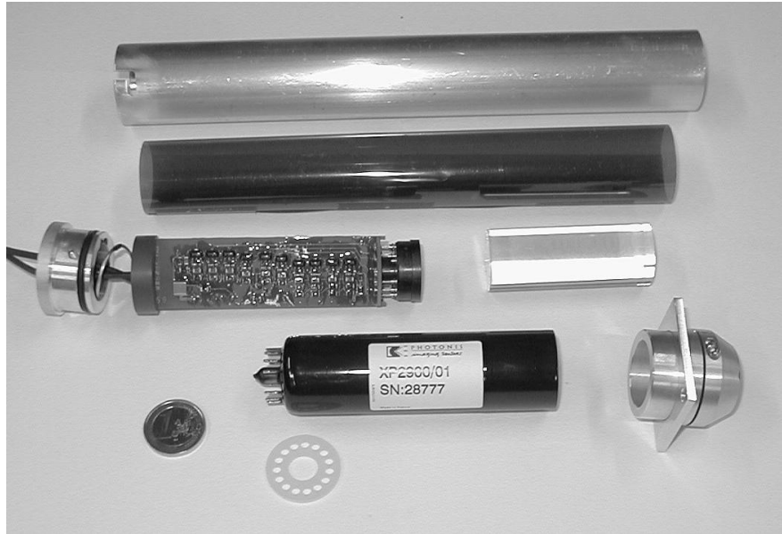
Abbildung 7.12: Photographie der Komponenten eines Zählers des H5I (ohne Szintillator). Abgebildet sind Base, Photomultiplier und Lichtleiter so wie das Aluminiumrohr mit einem Rohr aus isolierender Kaptonfolie und der Klemme für den Lichtleiter, die in diesem Fall in das Rohr geklebt wird. Nicht abgebildet ist ein Rohr aus Mumetall, das den Photomultiplier vor magnetischen Feldern schützt.
