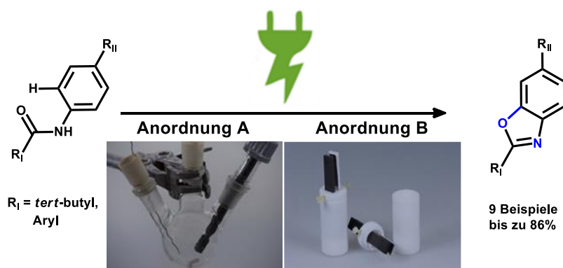
Schema 30: Synthese von Benzoxazolen mittels anodischer C-O-Bindungsknüpfung.
