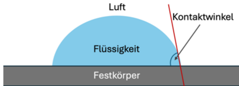
Abbildung 2: Kontaktwinkel zwischen einem Flüssigkeitstropfen und einem Festkörper
