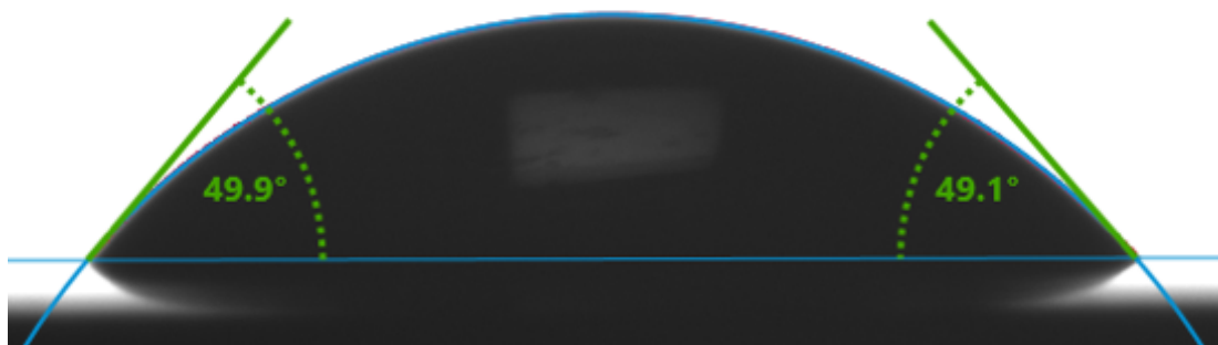
Abbildung 31: Kontaktwinkel eines 3 µl Wassertropfens auf einer Lithiumdisilikatkeramik Oberfläche ohne Plasmaexposition
