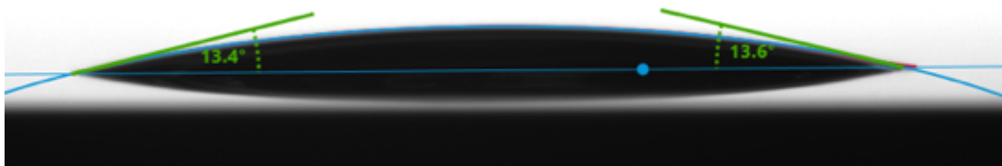
Abbildung 21: Kontaktwinkel eines 3 µl Wassertropfens auf einer Titanoberfläche nach 10 Sekunden Plasmaexposition
