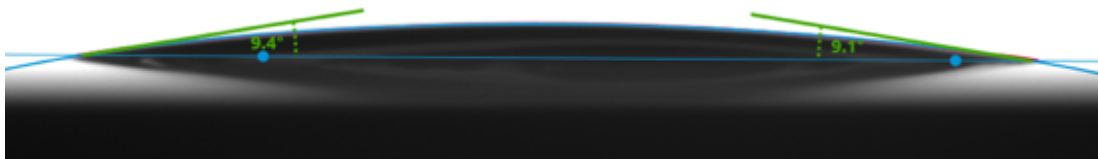
Abbildung 23: Kontaktwinkel eines 3 µl Wassertropfens auf einer Titanoberfläche nach 30 Sekunden Plasmaexposition
