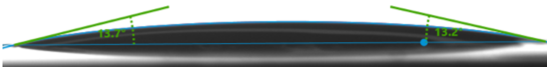
Abbildung 35: Kontaktwinkel eines 3 µl Wassertropfens auf einer Lithiumdisilikatkeramik Oberfläche nach 30 Sekunden Plasmaexposition
