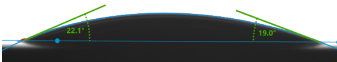
Abbildung 32: Kontaktwinkel eines 3 µl Wassertropfens auf einer Lithiumdisilikatkeramik Oberfläche nach 5 Sekunden Plasmaexposition
