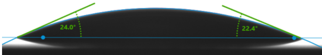
Abbildung 29: Kontaktwinkel eines 3 \mu\text{l} Wassertropfens auf einer Zirkoniumdioxidoberfläche nach 30 Sekunden Plasmaexposition
