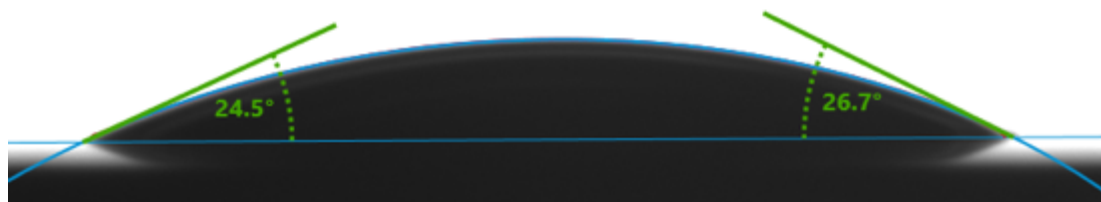
Abbildung 26: Kontaktwinkel eines 3 µl Wassertropfens auf einer Zirkoniumdioxidoberfläche nach 5 Sekunden Plasmaexposition
