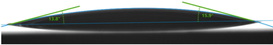
Abbildung 33: Kontaktwinkel eines 3 µl Wassertropfens auf einer Lithiumdisilikatkeramik Oberfläche nach 10 Sekunden Plasmaexposition
