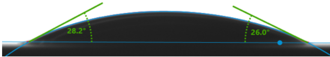
Abbildung 27: Kontaktwinkel eines 3 \mu\text{l} Wassertropfens auf einer Zirkoniumdioxidoberfläche nach 10 Sekunden Plasmaexposition
