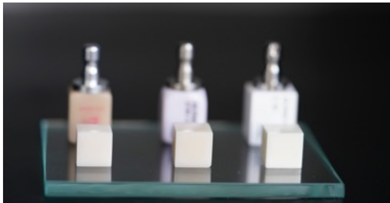
Abbildung 11: fertiggestellte Keramik Blöcke (von links nach rechts Enamic, IPS e.max CAD, e.max ZirCAD)
