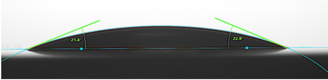
Abbildung 20: Kontaktwinkel eines 3 µl Wassertropfens auf einer Titanoberfläche nach 5 Sekunden Plasmaexposition
