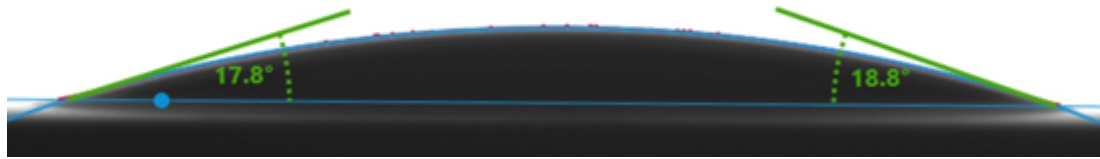
Abbildung 38: Kontaktwinkel eines 3µl Wassertropfens auf einer Hybridkeramikoberfläche nach 5 Sekunden Plasmaexposition.
