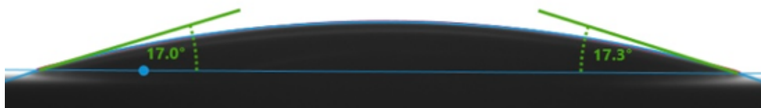
Abbildung 41: Kontaktwinkel eines 3µl Wassertropfens auf einer Hybridkeramikoberfläche nach 30 Sekunden Plasmaexposition.
