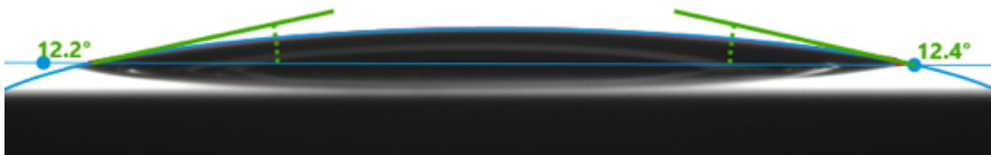
Abbildung 22: Kontaktwinkel eines 3 µl Wassertropfens auf einer Titanoberfläche nach 20 Sekunden Plasmaexposition
