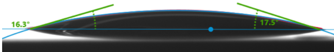
Abbildung 40: Kontaktwinkel eines 3µl Wassertropfens auf einer Hybridkeramikoberfläche nach 20 Sekunden Plasmaexposition.
