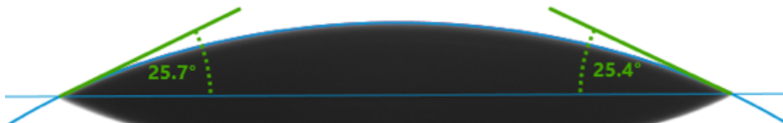
Abbildung 28: Kontaktwinkel eines 3 \mu\text{l} Wassertropfens auf einer Zirkoniumdioxidoberfläche nach 20 Sekunden Plasmaexposition
