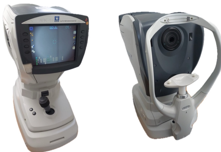
Abbildung 9: Beispielfoto des ARK-1s der Firma NIDEK® wie er in der GPES zur objektiven Refraktionsbestimmung verwendet wurde
