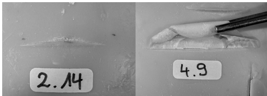
Abb. 72: Breitflächigere Ausbrüche und längere glatt durchtrennte Fläche beim Versuch mit der Hellebarde (rechts) im Vergleich mit einem Versuch mit dem Schwert (links) bei fast identischen Bedingungen. Bei V2.14 befindet sich auf der Abbildung die glatt durchtrennte Fläche oben. (Die Länge der weißen Etikette entspricht 20 mm.)
