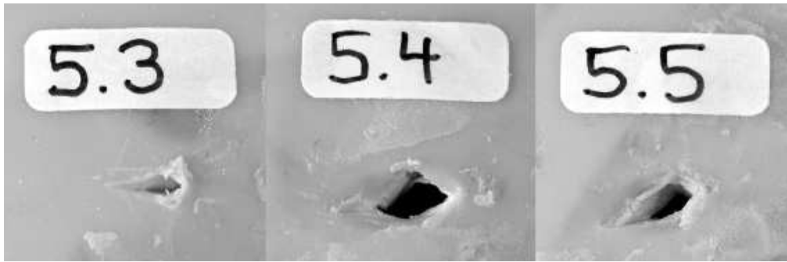
Abb. 82: Mit Waffe 5 erzeugte oberflächliche und penetrierende Defekte. (Die Länge der weissen Etikette entspricht 20 mm.)
