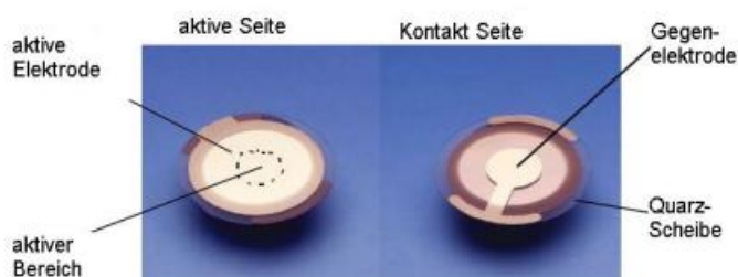
Abbildung 16: Piezoelektrischer Kristall oder Schwingquarz mit aktiver Elektrode und Gegenelektrode (Firma Q-Sense, SE-426 77 Västra Frölunda, Schweden).
