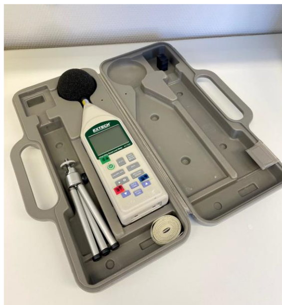
Abbildung 16: Verwendetes Gerät zur Aufzeichnung des Schallpegels
