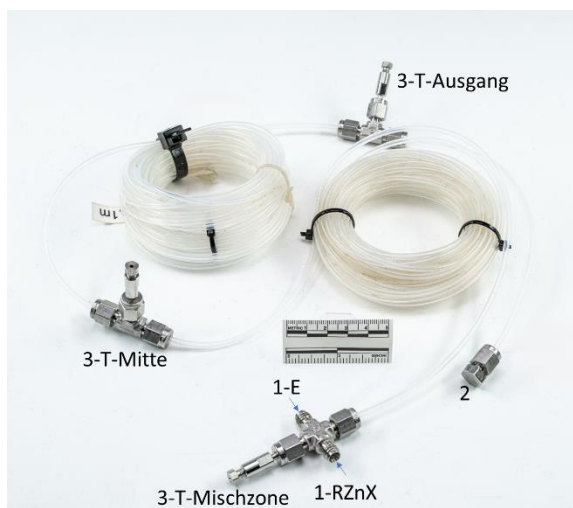
Abbildung 51: Am Fraunhofer IMM konstruierter Kapillarreaktor für die kontinuierliche Umsetzung von Organozinkhalogeniden RZnX im Labormaßstab, Maßstabsvergleich 5 cm. © Fraunhofer IMM.
