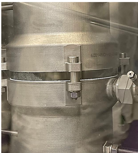
Abbildung 259: Lochbildung zwischen Reaktormodul M1 und M2 bei der Synthese von 2-CyanobenzylZnBr in THF (P2) im Pilotreaktor.
