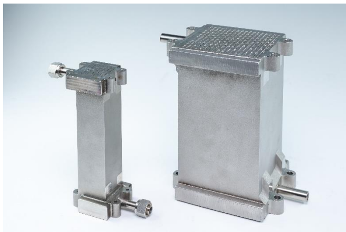
Abbildung 56: Am Fraunhofer IMM entwickelte Labor- und Pilot-Plattenstapelreaktoren zur nicht katalysierten Umsetzung von Organozinkhalogeniden RZnX, Boden und Deckel nicht im Bild enthalten. © Fraunhofer IMM.
