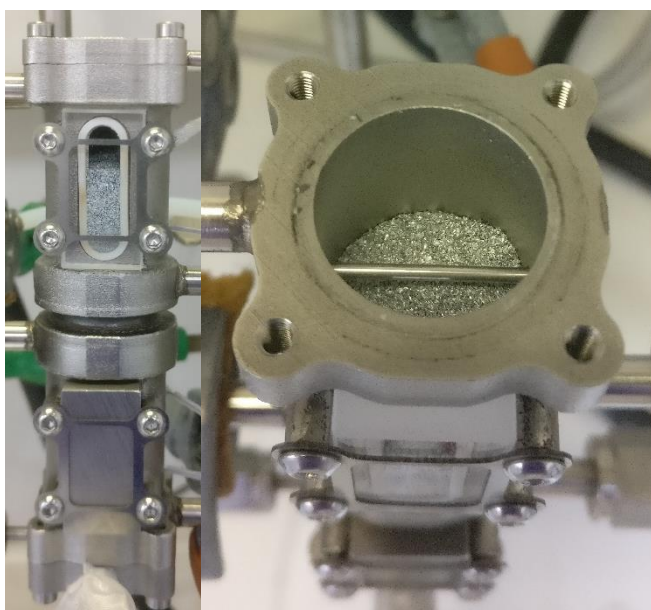
Abbildung 257: Zink-Verbrauch (ca. 25 g) ohne die Verwendung der Zinknachführvorrichtung am Ende der Synthese von 2,4-DichlorbenzylZnCl in THF im Labormaßstab.
