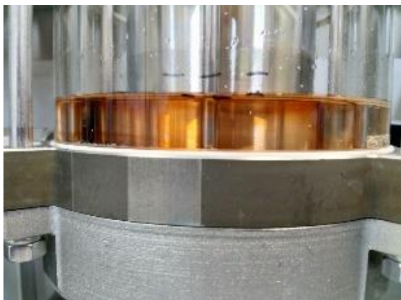
Abbildung 251: Ungleichmäßige Durchströmung des Tracers bei der Verweilzeitverteilungsmessung im mit Zn-Granulat gepackten Pilotreaktor.
