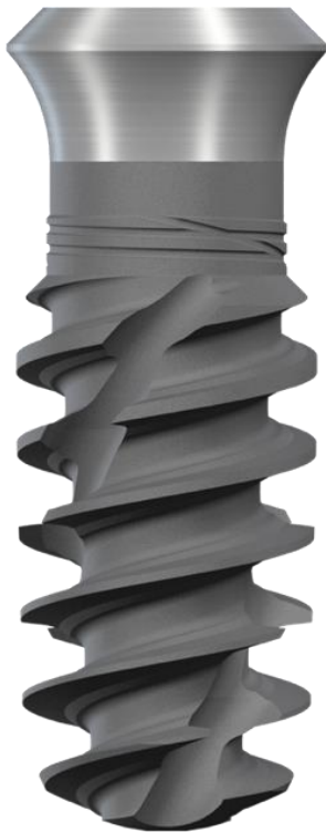
Abb. 14: Das untersuchte konische, selbstschneidende Tissue-Level Implantat (Straumann® TLX (Straumann, Basel, Schweiz))
