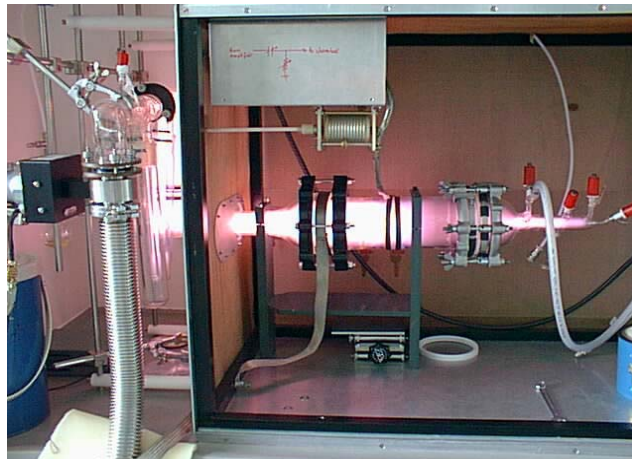
Abbildung 159 Reaktor für die Plasmapolymersation in einem in Betrieb. Das leuchtende Plasma wird durch ein radiofrequentes elektromagnetisches Wechselfeld von 13,56 MHz erzeugt.
