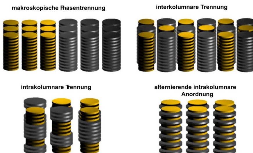
Abbildung 3-29: Schematische Darstellung der denkbaren supramolekularen Ordnungen bei Mischung von zwei unterschiedlichen diskotischen Komponenten [31]
