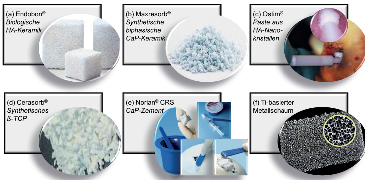
Abb. 3.5: Ausgewählte Beispiele von Knochenersatzmaterialien. [58-63]
