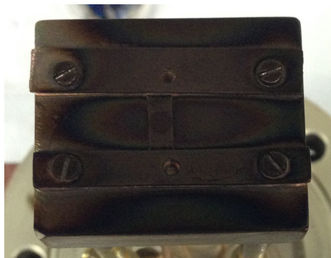
Abbildung 4.4: Probenhalter mit Fila- \alpha 3.
