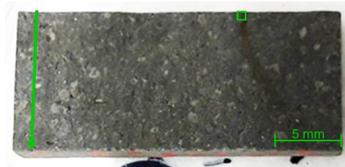
Abbildung 5.13: Untersuchte Position auf Probe OPA-NP, der Pfeil markiert die Diffusionsrichtung von Primär- zu Sekundärseite.
