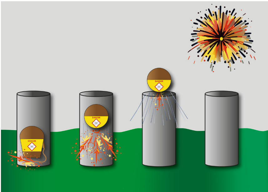
Abb. 1 ▲ Abschuss (Schritt 1: Zündung; Schritt 2: Explosion der Treibladung, die die Sphäre nach oben katapultiert; Schritt 3: weiterer Anstieg bis an den Kulminationspunkt mit Abbrennen des Verzögerungszünders; Schritt 4: Explosion des Feuerwerkskörpers)
