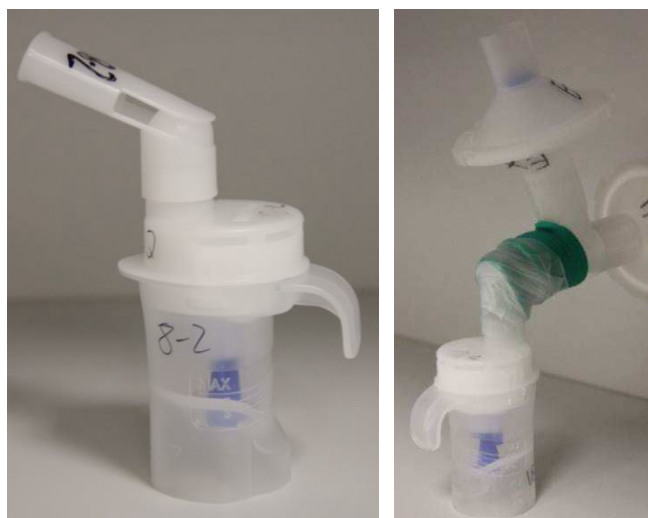
Abbildung 35: Aufbau des Verneblers Omron V.V.T.01 mit Mundstück und Konnektion über das Winkelstück aus der Maske an das Filtersystem des Atemzugsimulators.
