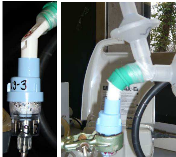
Abbildung 33: Aufbau des Verneblers Sidestream reusable mit Mundstück und Konnektion über das Winkelstück aus der Maske an das Filtersystem des Atemzugsimulators.
