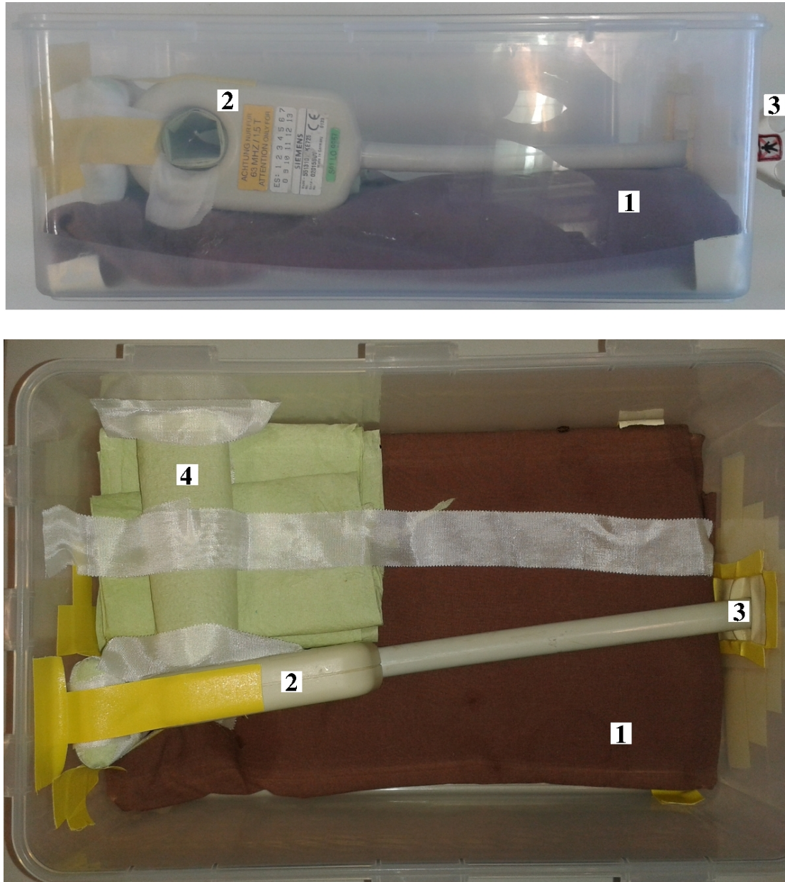
Abbildung 3.1: Sterile Barriere-Box. Darstellung der sterilen Barriere-Box in Seitenansicht und in Aufsicht von oben. Am Boden der Barriere-Box befindet sich das Wärmepack, abgedeckt mit einem sterilen OP-Tuch (1). Am linken Rand der Box ist die Handgelenksspule (2) fixiert, in die der Kopf der Mäuse gelegt wird. Nach rechts Außen ist der Anschluss (3) für das MRT-Gerät gelegt. Neben der Spule ist der Zellstoff zur Fixierung der Maus zu sehen (4). Die Box wird mit einem Deckel, der mit einer sterilen Gaze versehen ist, verschlossen. Die Gaze ermöglicht den sterilen Luftaustausch.
