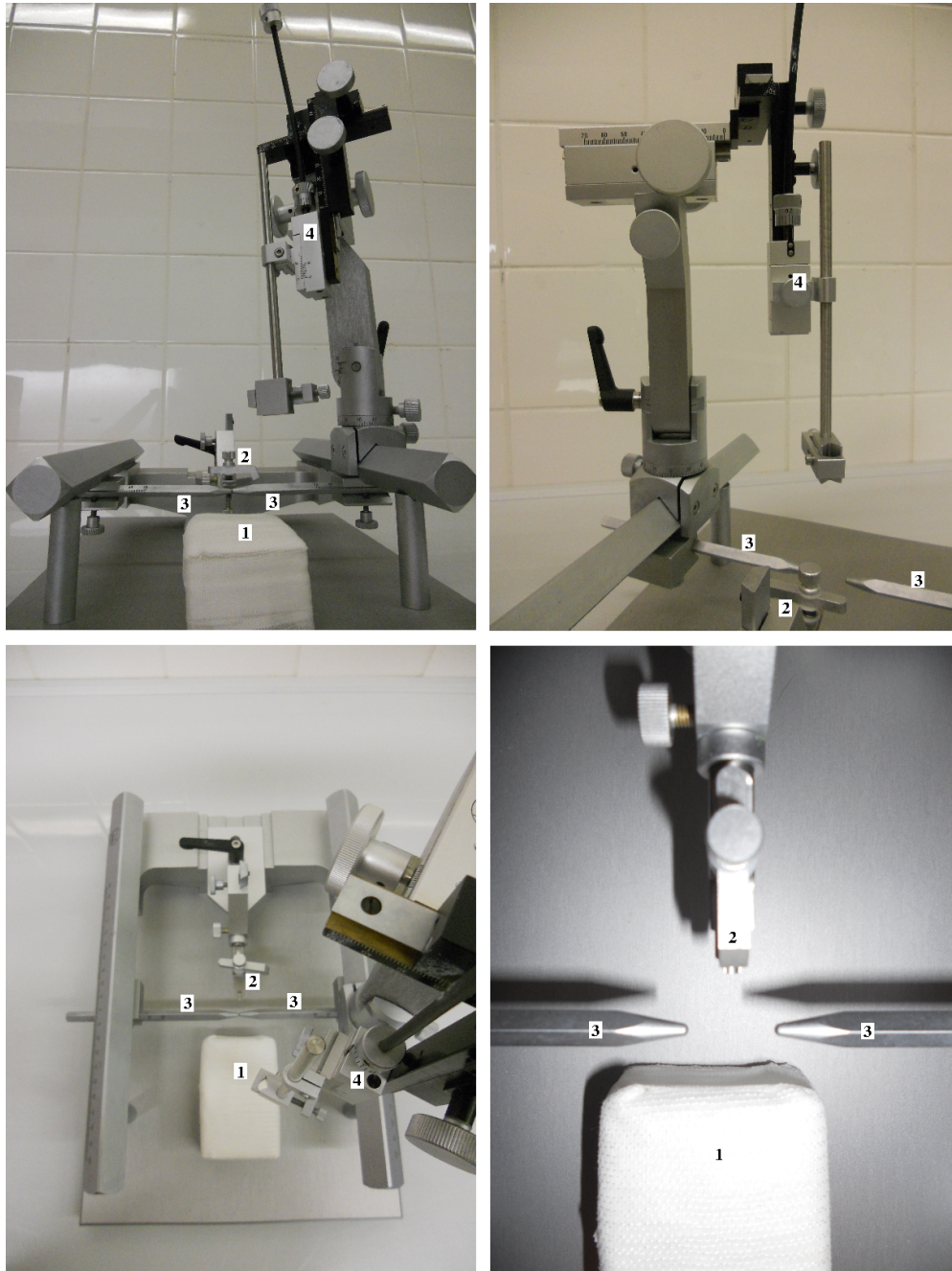
Abbildung 3.2: Stereotaktisches Gerät. Darstellung des stereotaktischen Geräts aus unterschiedlichen Perspektiven. Die Tiere werden auf dem OP-Tisch (1) platziert, die Zunge zur Seite gelegt und der Kopf mit den Zähnen auf dem Gebissstück (2) und den Fixierstäben (3) in den Ohren fixiert. In die freie Taxiereinheit (4) wird eine Hamiltonspritze justiert. Die Spritze wird an die entsprechende Stelle über dem Kopf der Maus fixiert und dann in den Schädel der Maus wenige Millimeter eingelassen.
