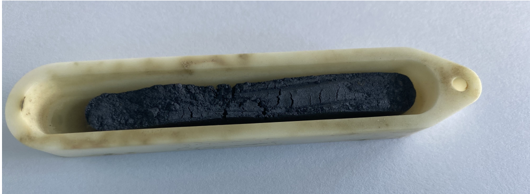
Abbildung 4.3: Bild des phasenreinen, tiefvioletten \text{FeVO}_4 -Pellets das nach der Aufarbeitung im Argonstrom im Schiffchen zurückgeblieben war.
