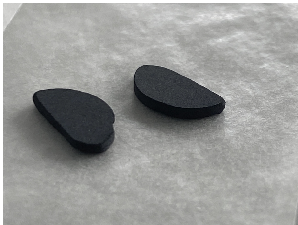
Abbildung 4.1: Undotiertes \text{FeMoO}_4 wurde nach der Synthese im Muffelofen bei 1075K zu Presslingen verarbeitet um weitere Untersuchungen damit durchzuführen.
