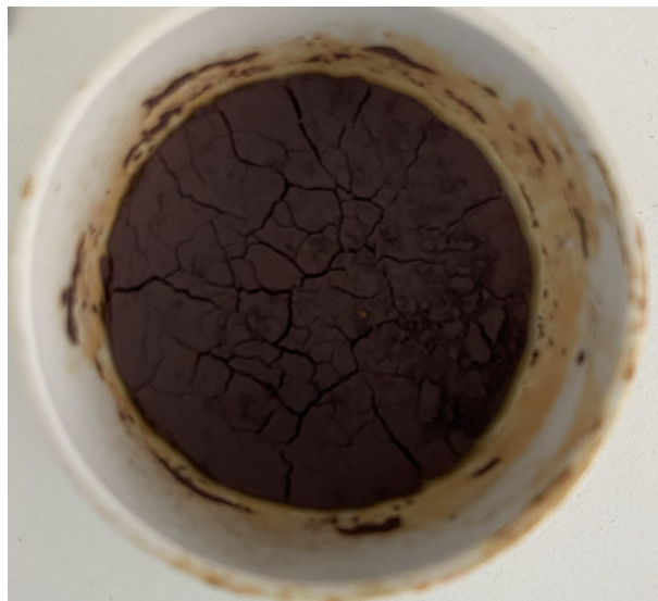
Abbildung 4.2: Das gesinterte FeVO 4 im Tiegel besteht zu diesem Schritt schon zu mehr als 94% aus FeVO 4 und muss mit einem Überschuss an V 2 O 5 im Argonstrom aufgereinigt werden.
