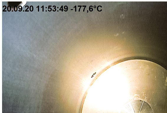
(a) Unbeschichtet, unteres Drittel und Bodenplatte, homogene Oberfläche.
