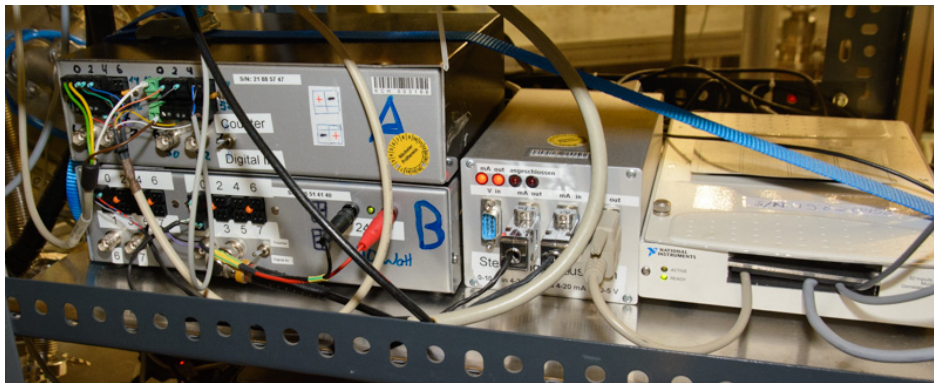
Abbildung 4.8.: Elektroneinheiten zur Steuerung des Kühlsystems: Rechts: USB-6259, Mitte: Messumformer für Einheitssignal, Links: zwei USB-6259 mit entsprechender Spannungsversorgung aller Kanäle.
