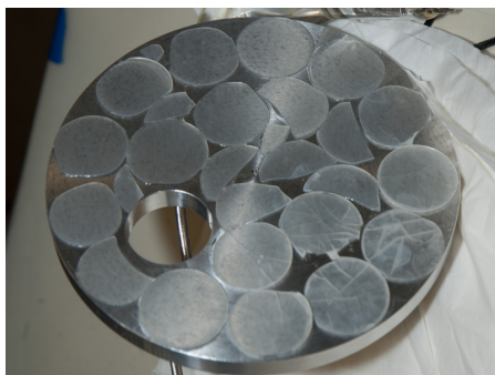
(a) Der 2013 eingesetzte Absorber aus Lithiumstearat.
