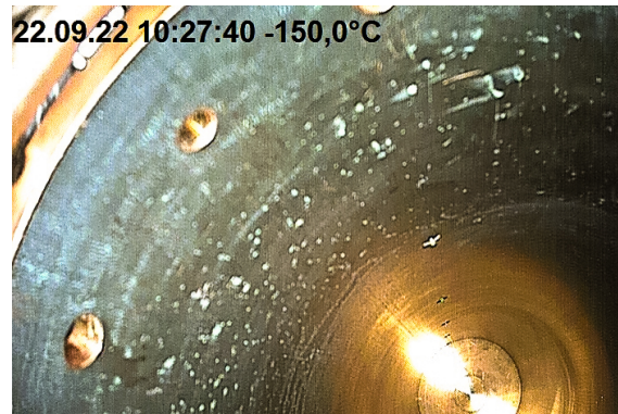
(b) Unbeschichtet, oberes Drittel, unregelmäßige Strukturen sichtbar (möglicherw. Verschmutzung).
