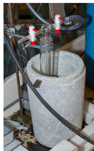
Abbildung 4.13.: Kühlfalle im Styropor-Dewar.
