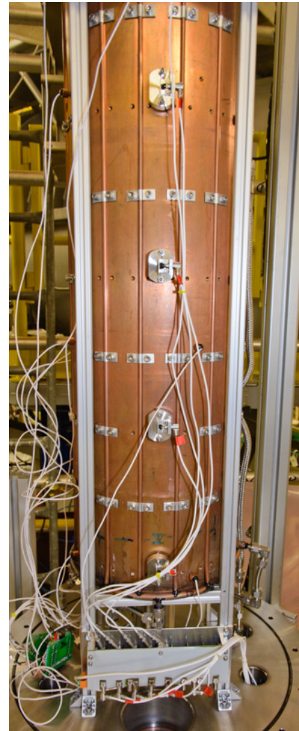
Abbildung 4.18.: UCN-Detektoren und Vorverstärker am Speicherrohr.
