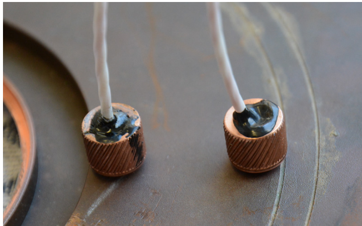
(b) Foto von zwei eingebauten Temperatursensoren in der Bodenplatte. Die vierpolige Anschlussleitung ist eingeklebt.
