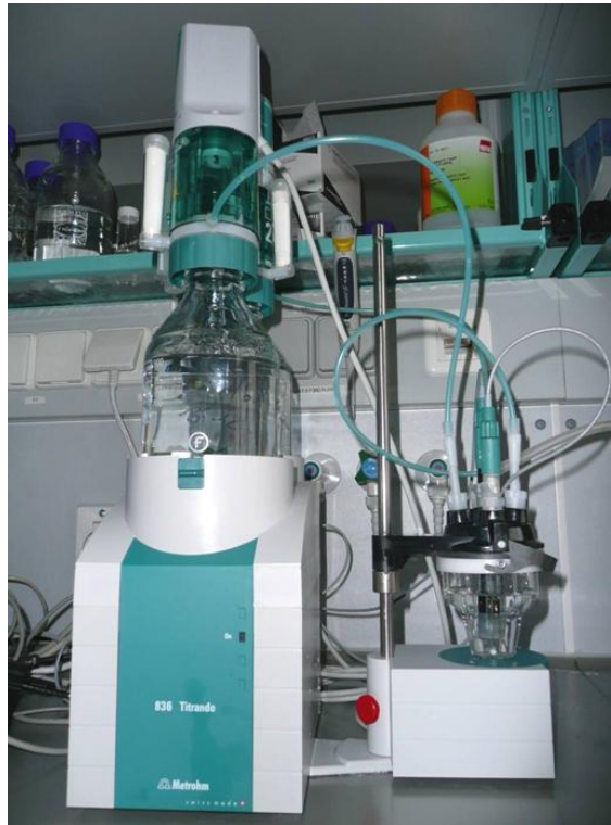
Abbildung 56: Aufbau der Computer-gesteuerten simultanen Titration von Calcium-Ionen und des pH-Wertes.
