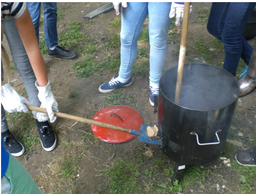
Abbildung 13: Eintopf-Ofen wird mit Weichholzbriketts befeuert.
