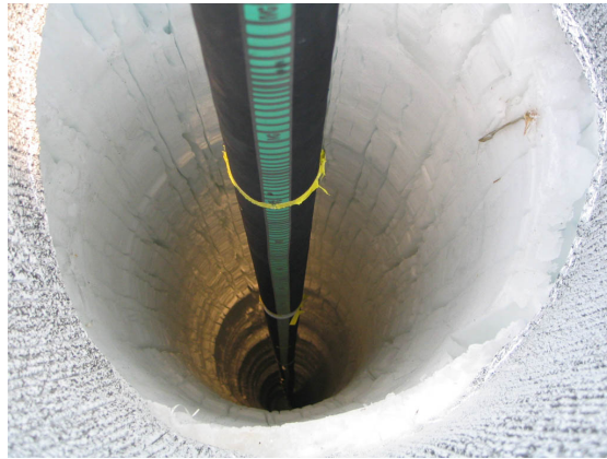
Abbildung 2.8: Versenken einer Trosse im gebohrten Loch. Der Bohrdurchmesser beträgt etwa 60 cm (aus [28]).
