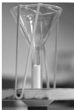
Abb. 3.22. Modifizierung des Stampfvolumeteraufsatzes zur Bestimmung von Schütt- und Stampfdichte kleiner Mengen.
