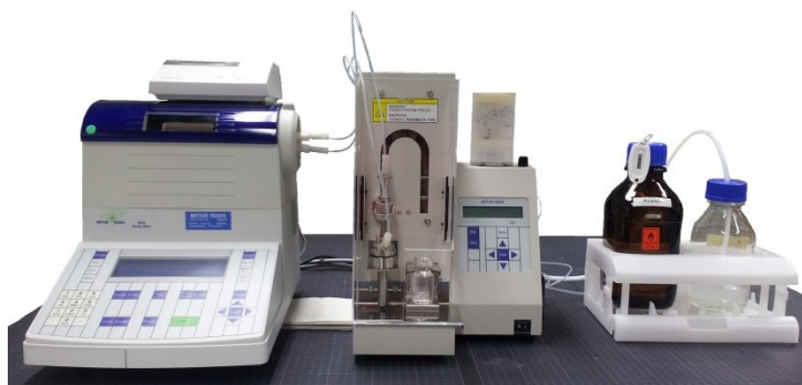
Abbildung 53: Dichtemessgerät Mettler Toledo D45 mit Probenzufuhr und Reinigungseinheit SC1.
