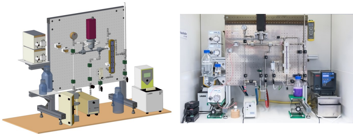
Abbildung 81: CAD-Zeichnung von Silvio Kraus angefertigt (links) und deren Umsetzung als Aufbau im Labormaßstab (rechts).
