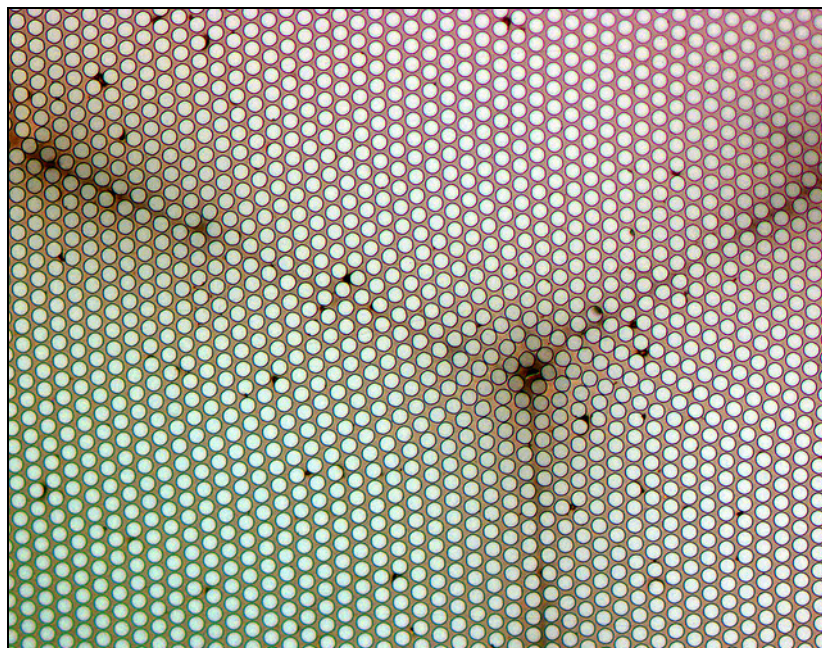
Abb. 31: Lichtmikroskopaufnahme (Auflicht) einer MCP, Lochdurchmesser 10 \mu\text{m} . Bildfläche: 574 \times 450 \mu\text{m}^2 .
