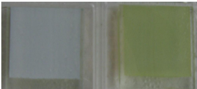
Abb. 3.37 Benetzung von TiO 2 -Platten mit LHCII-Trimeren. TiO 2 -Platten aus eigener Herstellung vor (links) und nach (rechts) Benetzung mit LHCII-Lösung.
