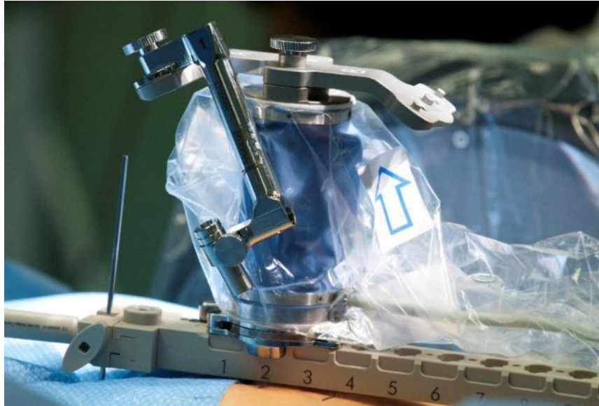
Abbildung 26: Roboter-Einheit auf Position 2 der Brücke platziert mit auf Trajekt ausgerichtetem Arbeitskanal. Foto Peter Pulkowski.
