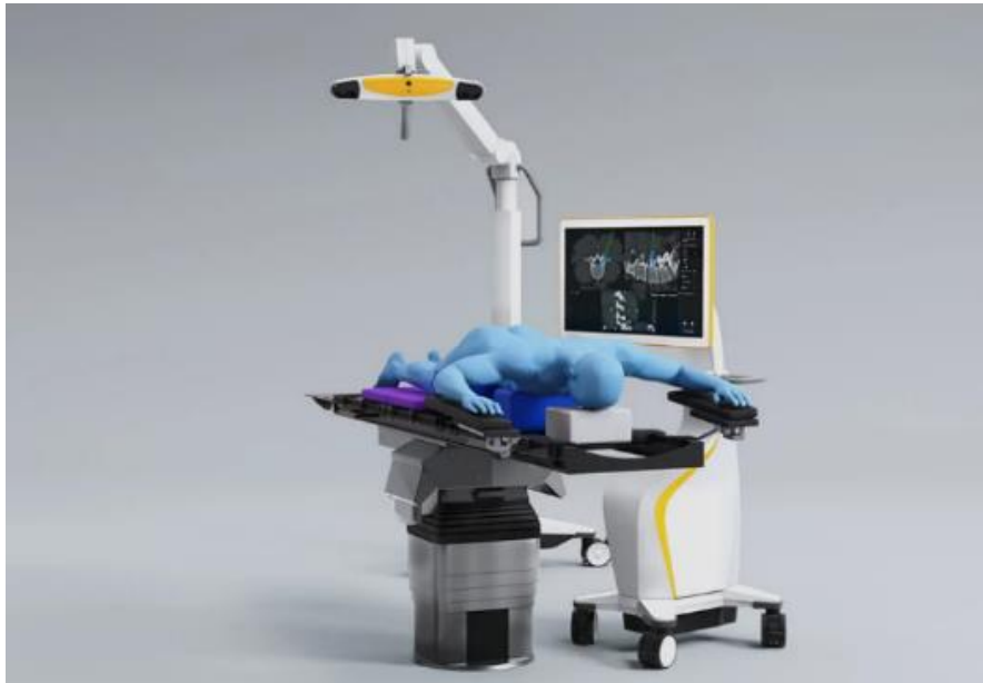
Abbildung 27: Beispiel eines intraoperativen Setups für eine spinale Navigation. Patient in Bauchlage. Einsicht der Kamera auf das OP-Feld, Live-Visualisierung auf der Monitor-Einheit. Quelle: ©Brainlab. https://www.brainlab.com/cdn-cgi/image/w=1023,f=webp/https://assetmanagement.brainlab.com/Images/newcurve_or_configs_v003_rgb_03_new_1024x768.jpg
