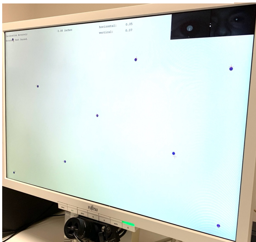
Abbildung 10: Kalibrierungsvorgang mit 9 Referenzpunkten; Rote Kreuze: Referenzpunkte, die vom Betrachtenden fixiert werden sollen; Blaue Punkte: realen Blickpunkte des Betrachtenden; kleine Abweichungen zwischen Referenzpunkte und Blickpunkte werden von dem System akzeptiert
