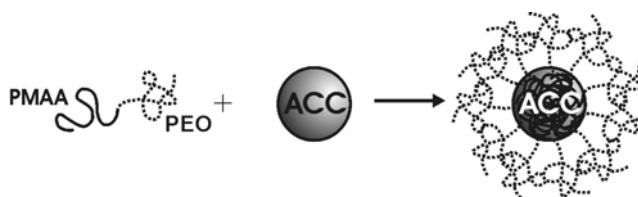
Abbildung 4.28 - Stabilisierender Effekt von Blockcopolymeren durch partielle Adsorption der PMAA-Einheit auf dem ACC-Partikel. Die PEO-Einheiten bewirken eine sterische Stabilisierung.
