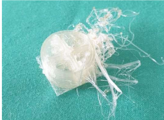
Abbildung 18 - Druckmodell mit Stringing (Eigene Aufnahme)
