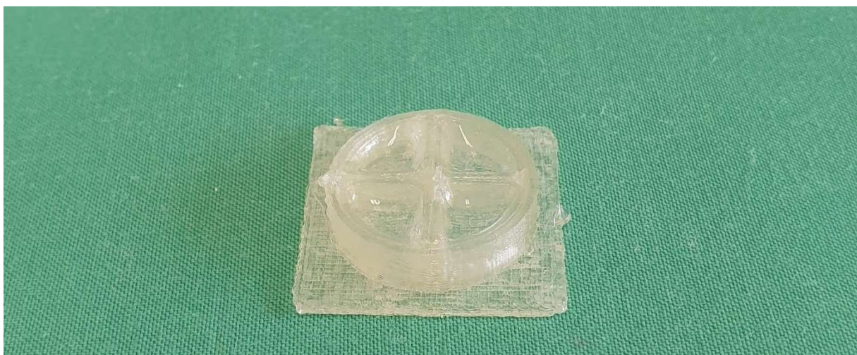
Abbildung 21 - Erfolgreicher Testdruck in vorgefertigtes Kunststoffmodell mit ermittelter Zielkonzentration des Hydrogels (3% Agarose) (Eigene Aufnahme)
