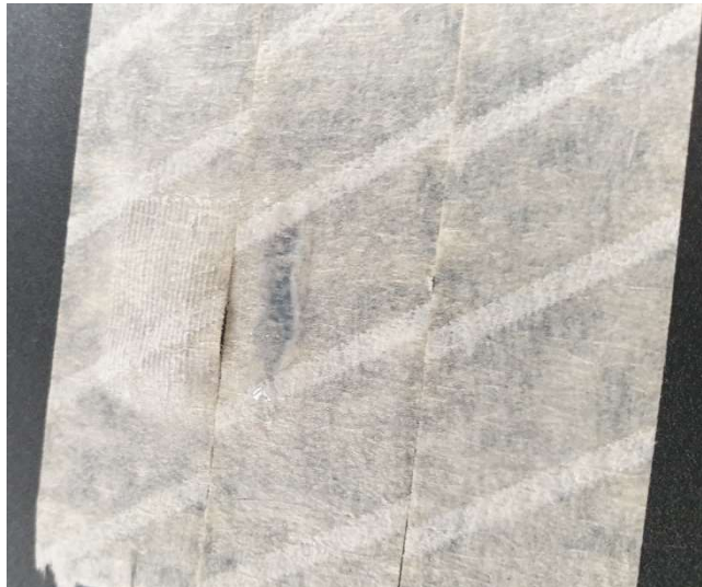
Abbildung 27 - Dislokation beim Kombinationsdruck nach Austreten von Hydrogel (Eigene Aufnahme)
