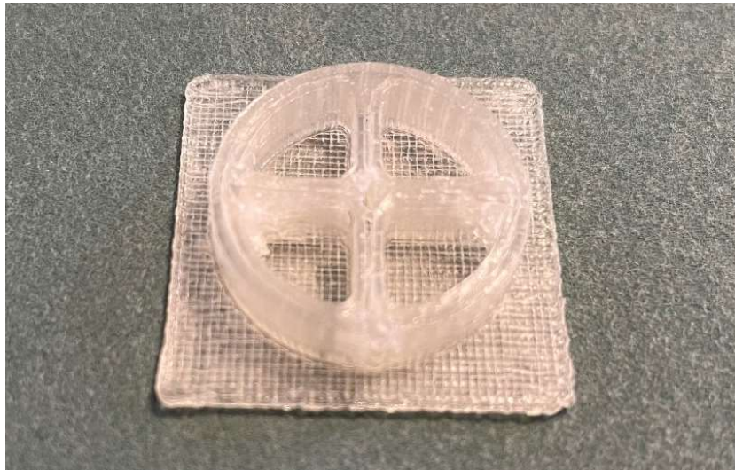
Abbildung 29 - Finales PLA-Scaffold mit dichtem Raft für den kombinierten Druck (Eigene Aufnahme)
