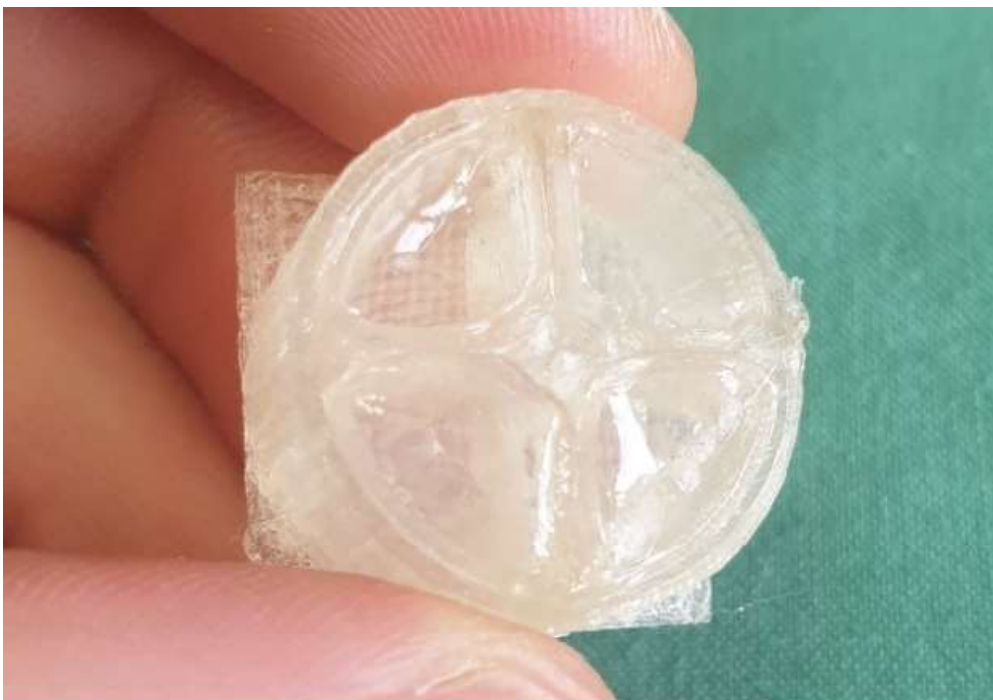
Abbildung 30 - Erfolgreicher Kombinationsdruck von PLA und Agarose (3%) (Eigene Aufnahme)
