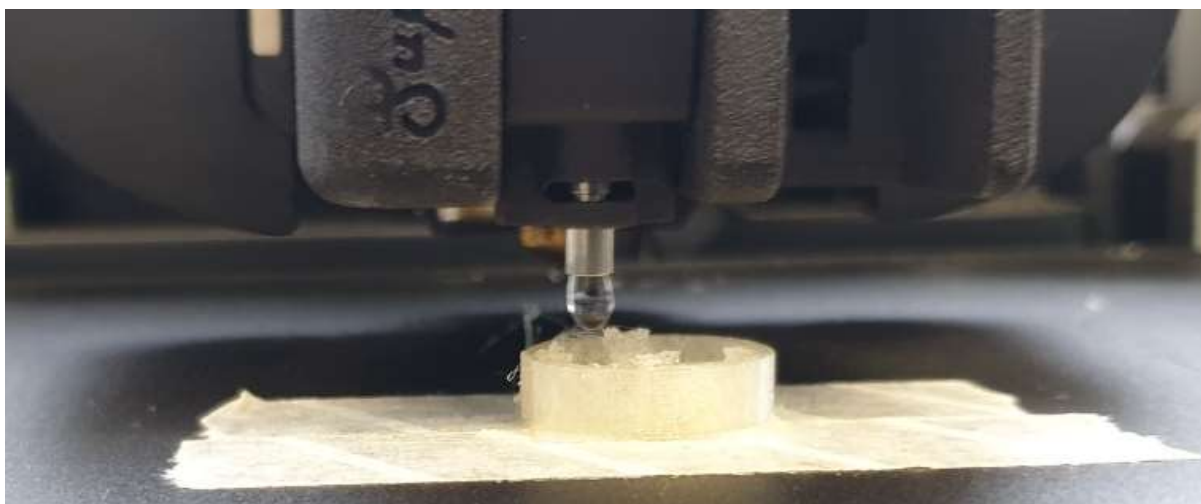
Abbildung 24 - Fehlschlag eines Drucks wegen Ansammlung eines Hydrogel-Tropfens an der DoD-Düse (Eigene Aufnahme)
