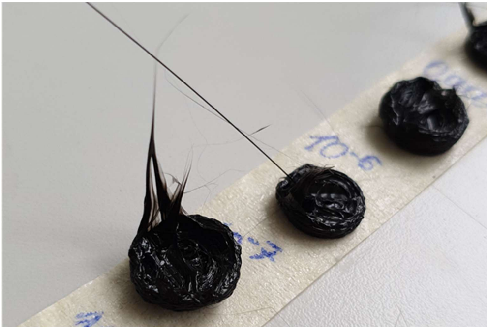
Abbildung 17 - PLA-Konstrukt mit Überextrusion (Eigene Aufnahme)
