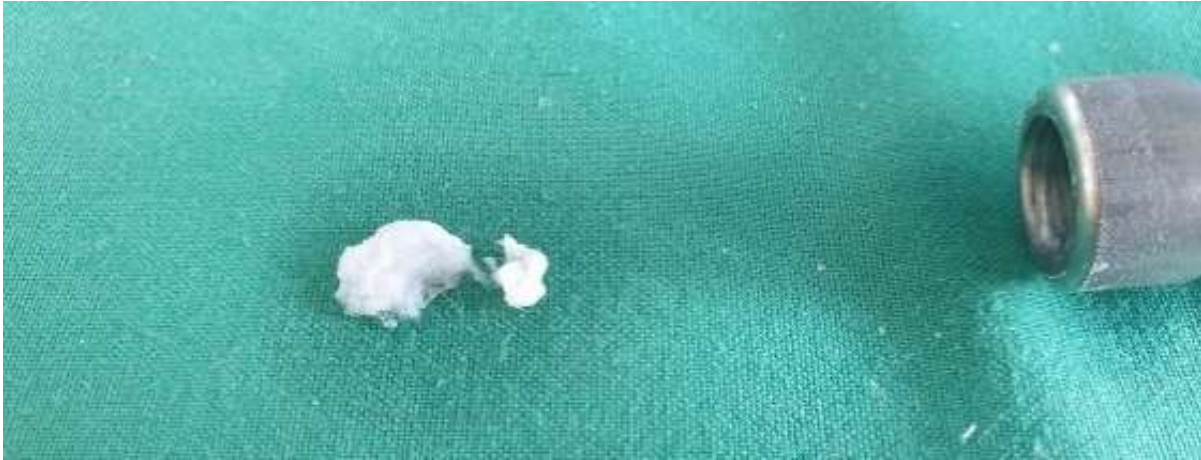
Abbildung 23 - Agglomerat nach 2% w/v Agarose-Testdruck (Eigene Aufnahme)
