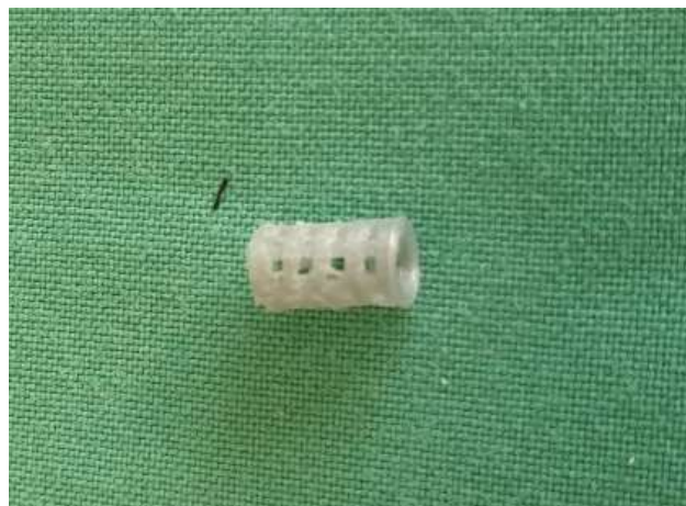
Abbildung 15 – Filamentdruck eines porösen Kunststoffmodells (Eigene Aufnahme)
