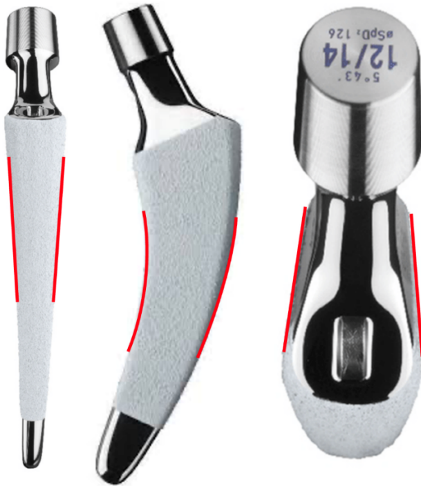
Abbildung 11: optimys Schaft der Firma Mathys im charakteristischen Triple Taper Design. Die roten Markierungen zeigen das konische Design in 3 Ebenen, modifizierte Abbildung (116).
